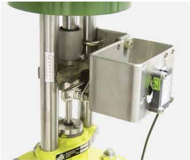
NCS (6DR4004-N.30) для хода > 14 мм (0,55 дюйма), установленный с помощью монтажного комплекта для поступательного привода NAMUR
