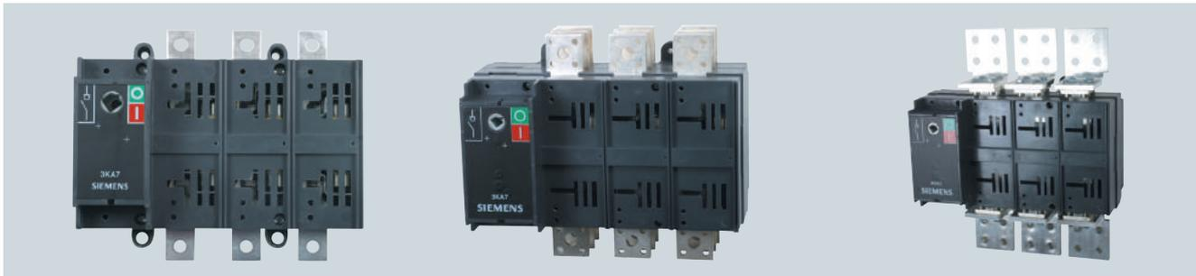
Gli interruttori di manovra-sezionatori SENTRON 3KA71 sono adatti per i seguenti impieghi: interruttori di sicurezza, comando di utenze sottocarico, comando di carichi in corrente continua, sezionatori, comando di motori secondo le categorie di impiego AC-21 A - AC22 A - AC-23A. Possono essere utilizzati in impianti con tensione di isolamento fino a 1000 V - 50/60 Hz e fino a 1500 V DC.
