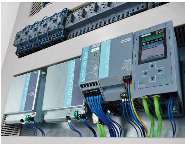
Bild 1: Pufferung des 24-V-Steuerstromkreises mit Stromversorgung SITOP PSU100S, DC-USV-Modul SITOP UPS1600 und 2 Batteriemodule SITOP UPS1100. Die DC-USV ist über PROFINET in das Automatisierungssystem integriert.
