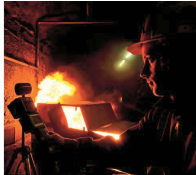
Hagerbachin koetunnelissa FibroLaser-järjestelmää testataan aidoissa olosuhteissa....
