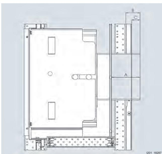
Расположение носителя приборов в самом низком монтажном положении. При подключении на задней панели внутреннее разделение «вертикально сзади».
