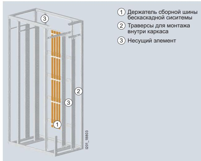
Бескаксадная система вспомогательных распределительных шин
