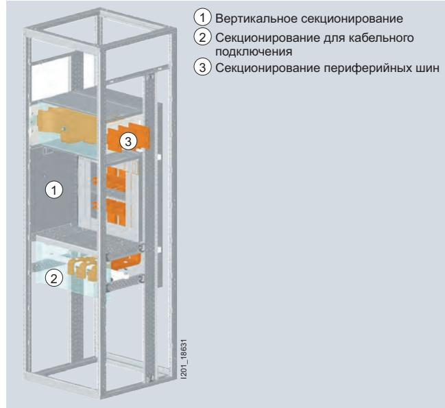
Система соединительных шин и секционирование формы 4b.
