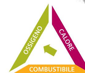
Rimozione Ossigeno (Es. Gas Inerti)
