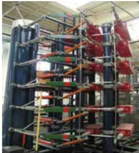
Der Test-Generator liefert beides: Impulsspannungen (1,2 / 50  $\mu$ s und 250/250  $\mu$ s) und Impulsströme (8/20  $\mu$ s und 30/60  $\mu$ s)
