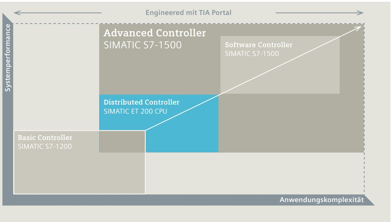
Für die unterschiedlichsten Automatisierungsanforderungen bietet Siemens den passenden Controller. Die neue Generation der SIMATIC Controller, bestehend aus Basic, Advanced, Distributed und Software Controller, überzeugt durch ihre Skalierbarkeit und Durchgängigkeit.
