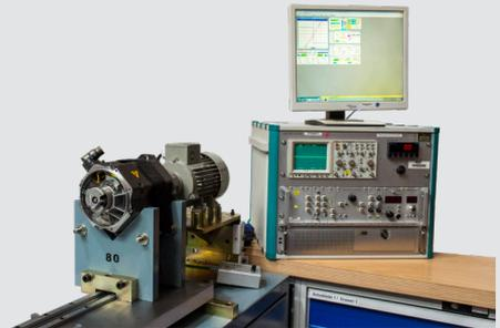
Todos los servomotores reparados son probados en un banco de pruebas de Siemens diseñado para simular las condiciones de la máquina con el fin de verificar que su unidad esté funcionando en condiciones óptimas.
