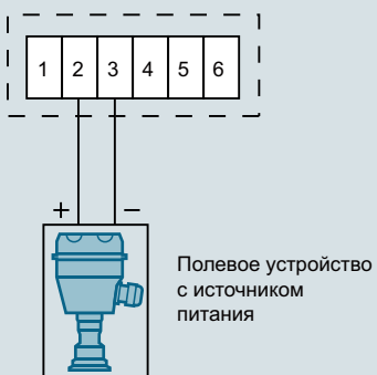
Подключение 4-проводного полевого устройства
