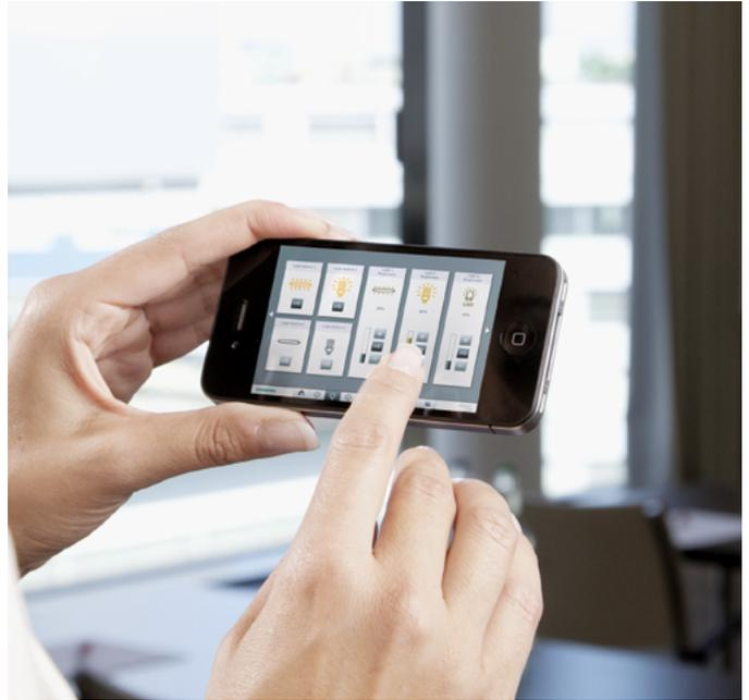
Smart Room Operator ist die innovative Raumbedienung via PC, Smartphone und Tablet. Die Bedienseiten basieren auf modernster Webtechnologie (HTML 5) und laufen mit jedem aktuellen Browser. Plug-Ins oder Apps sind nicht erforderlich.
