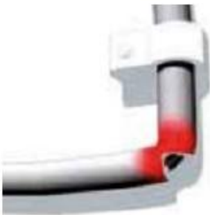
Figura 9: Rottura del cavo.
