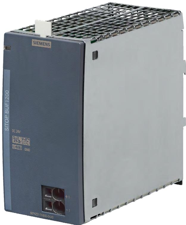
Das kompakte Puffermodul SITOP BUF1200 im robusten Metallgehäuse überbrückt kurze Netzausfälle bis in den Sekundenbereich. Je nach Laststrom überbrückt es 300 ms (bei 40 A), 600 ms (bei 20 A) oder 1.200 ms (bei 10 A). Um die Überbrückungszeiten weiter zu verlängern, können bis zu 5 Puffermodule SITOP BUF1200 parallelgeschaltet werden.
