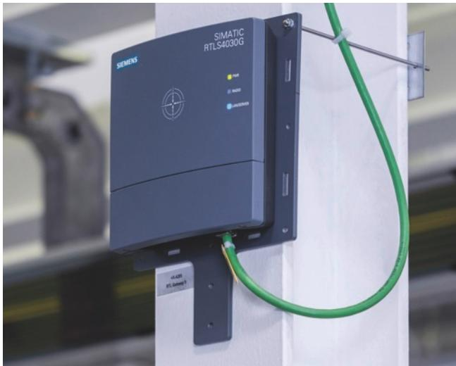
Anchors und Gateways liefern das „Wo“ zu allen mobilen Objekten – von Fertigungs-Equipment über Materialien und Bauteile bis zum fertigen Erzeugnis.
