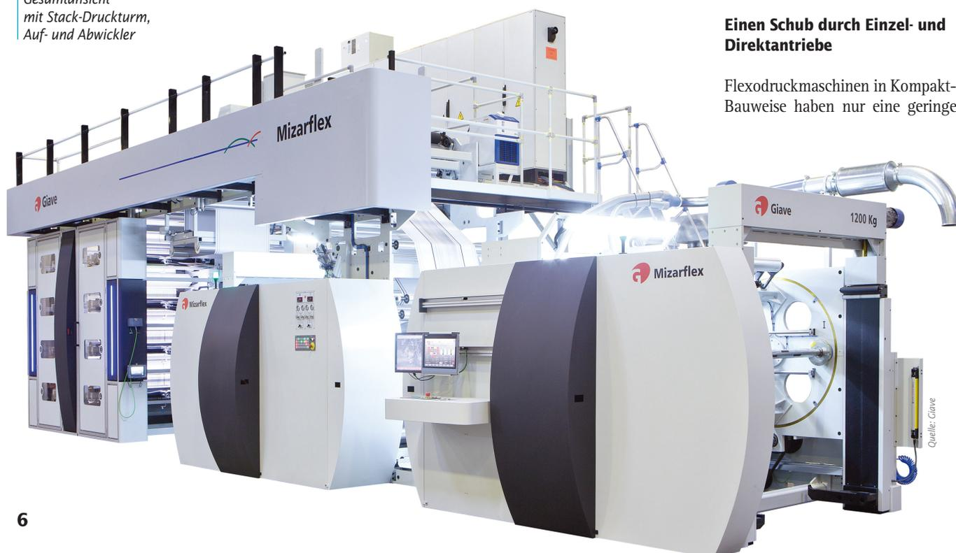
Marktakzeptanz. Zu statisch, ergo unflexibel sei die Bauart, so der Tenor. Genau an diesem Punkt setzte der spanische Maschinenbauer Giave an und entwickelte mit der Mizarflex einen wirklich getriebelosen Mehrzylinder-Flexodruckmaschinentyp und rüstete diesen vor allem auf der elektronischen Seite massiv auf. Mittlerweile ist daraus eine komplette Reihe entstanden, mit – je nach Kundenwunsch – vier, sechs, acht oder zehn Druckwerken,
