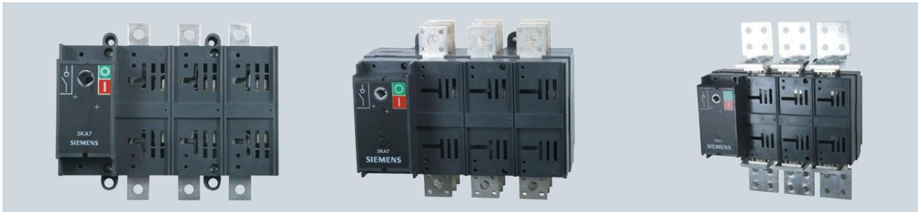
Gli interruttori di manovra-sezionatori SENTRON 3KA71 e gli interruttori-sezionatori con fusibili SENTRON 3KL71 sono adatti per i seguenti impieghi: interruttori di sicurezza, comando di utenze sottocarico, comando di carichi in corrente continua, sezionatori, comando di motori secondo le categorie di impiego AC-21 A - AC22 A - AC-23A. Possono essere utilizzati in impianti con tensione di isolamento fino a 1000 V - 50/60 Hz e fino a 1500 V DC.
