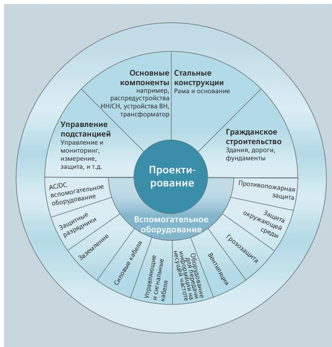
Рис. 3.1-1: Проектирование высоковольтного РУ
