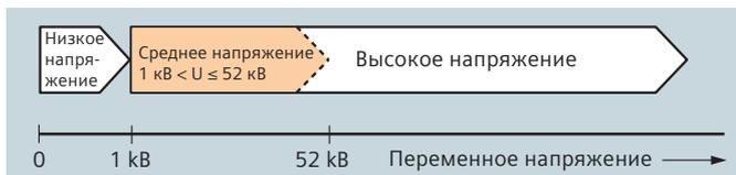
Рис. 3.2-2: Определение уровней напряжения
