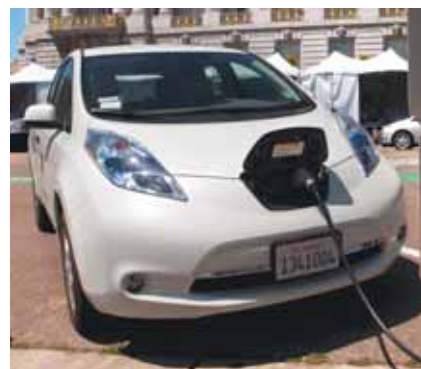
Le batterie possono agire da dispositivi di immagazzinamento temporaneo di energia e contribuire a stabilizzare reti e centrali elettriche.
