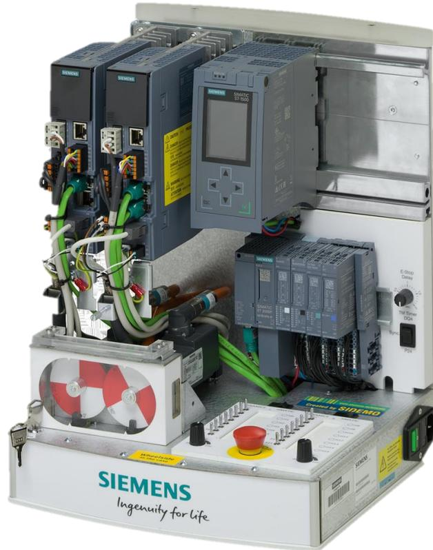
Testkoffer mit ET200SP – CPU
