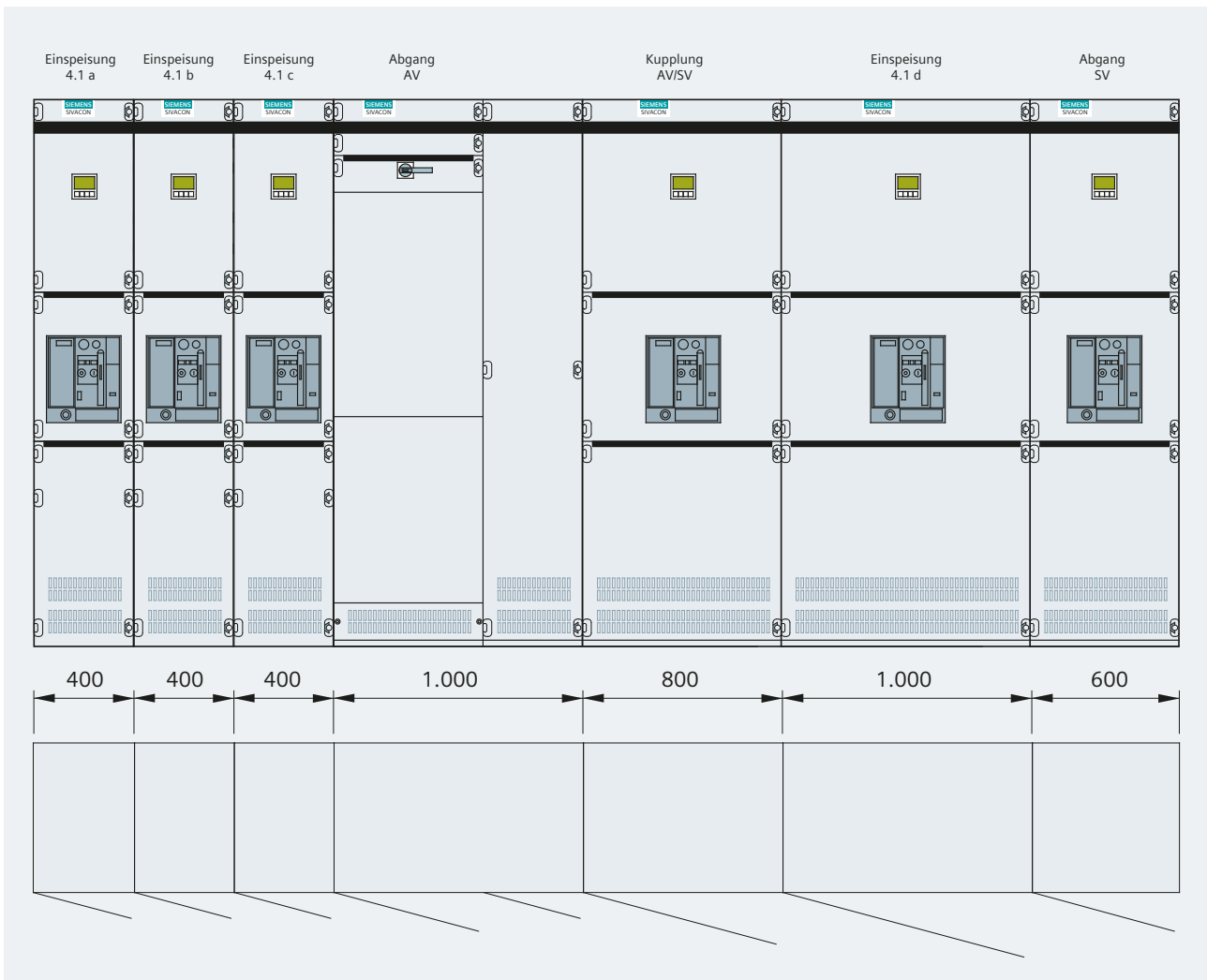
Abb. 5/11: Niederspannungsschaltanlage SIVACON S8 für die Hauptverteilung der Abfülllinie 1 (Maße in mm)
