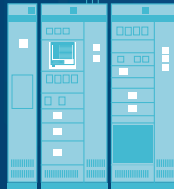
Schaltanlage SIVACON S8
