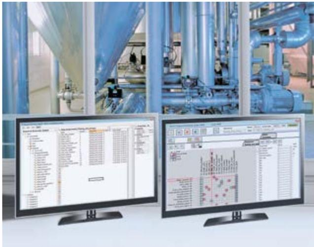
WinCC/SES (Sequence Execution System) ist eine Software für die Ablaufsteuerung von rezept- und sequenzbasierten Vorgängen wie z.B. Mischvorgängen in der Nahrungsmittelproduktion. Durch vorgefertigte Visualisierungstemplates und Funktionsbausteine wird eine hohe Engineering Effizienz erzielt, da der Anlagenbauer bzw. -projektor dadurch sowohl Engineering- als auch Test- und Inbetriebnahmezeit spart.
