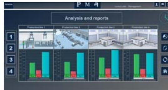
Störgrundanalysen geben Aufschluss über die Häufigkeit und Dauer von Maschinen- oder Anlagenstillständen. Entsprechende Anzeigeelemente können mühelos in WinCC Prozessbilder integriert werden.
