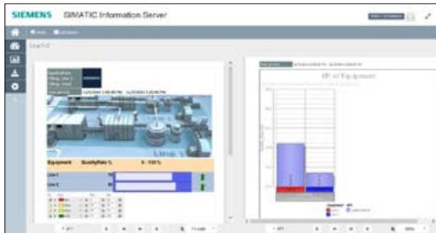
Der SIMATIC Information Server bietet webbasierten Zugriff auf Daten der Produktion und des SIMATIC Process Historian und kommt in jeder Ebene der Automatisierungspyramide zum Einsatz.
