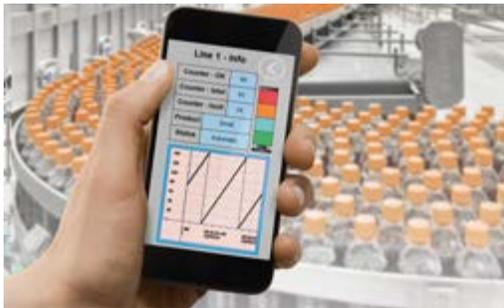
WinCC/WebUX wurde für den geräteunabhängigen Einsatz auf Smartphones, Tablets, PCs und anderen mobilen Geräten entwickelt, die einen HTML 5-fähigen Browser unterstützen. Für den Einsatz von WebUX ist keine client-seitige Installation erforderlich.
