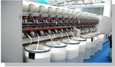
图 4：日发纺机气流纺纱机
