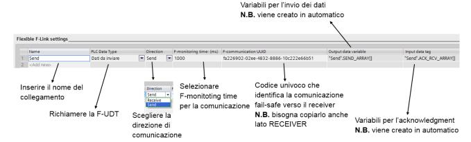
3. <u>Dichiarare le variabili da inviare</u>: all'interno del Main Safety appoggiare il valore delle variabili ai dati inseriti nella F-UDT. Una volta creata la F-Communication come al punto 2, in automatico in TIA PORTAL viene generata sotto la cartella *Blocchi di sistema → Step7 Safety → F-communication DB*s una DB dove sono contenuti tutti i dati relativi alla comunicazione creata; in questa DB, come si può notare dall'immagine, sono presenti i dati della F-UDT
