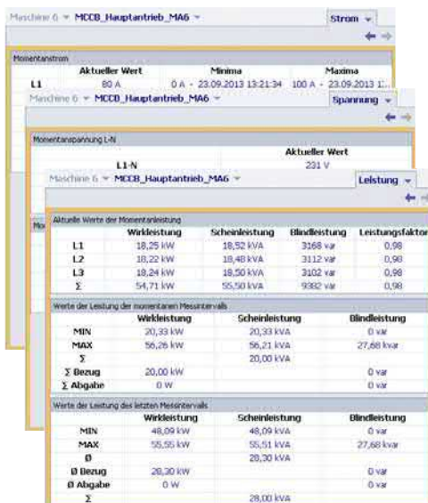
Náhled na power-configuratör, zde je zobrazen stav jističe (zap/vyp) a proudové zatížení kompaktního jističe 3VA2
