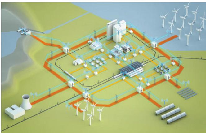
Рис. 1-3: Интеллектуальная сеть гарантирует, что источники возобновляемой энергии смогут лучше интегрироваться в общую систему благодаря двустороннему перетоку энергии (оранжевая линия) и реверсивному обмену коммуникационными данными (синяя линия). Тогда как генерация энергии в традиционных системах зависит от уровня потребления, интеллектуальная сеть способна контролировать потребление в зависимости от доступности электрической энергии в сети.
