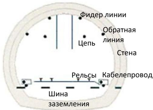
Рис. 2-42. Многопроводниковая система
