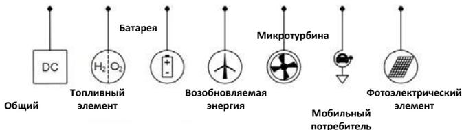
Рис. 1-10. Обозначения элементов, работающих на постоянном токе
