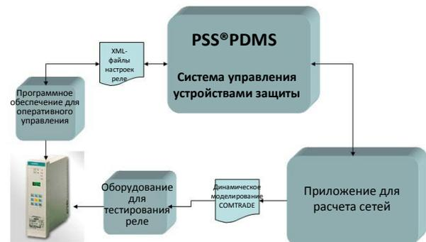
Рис. 2-22. Схема передачи данных об устройствах защиты
