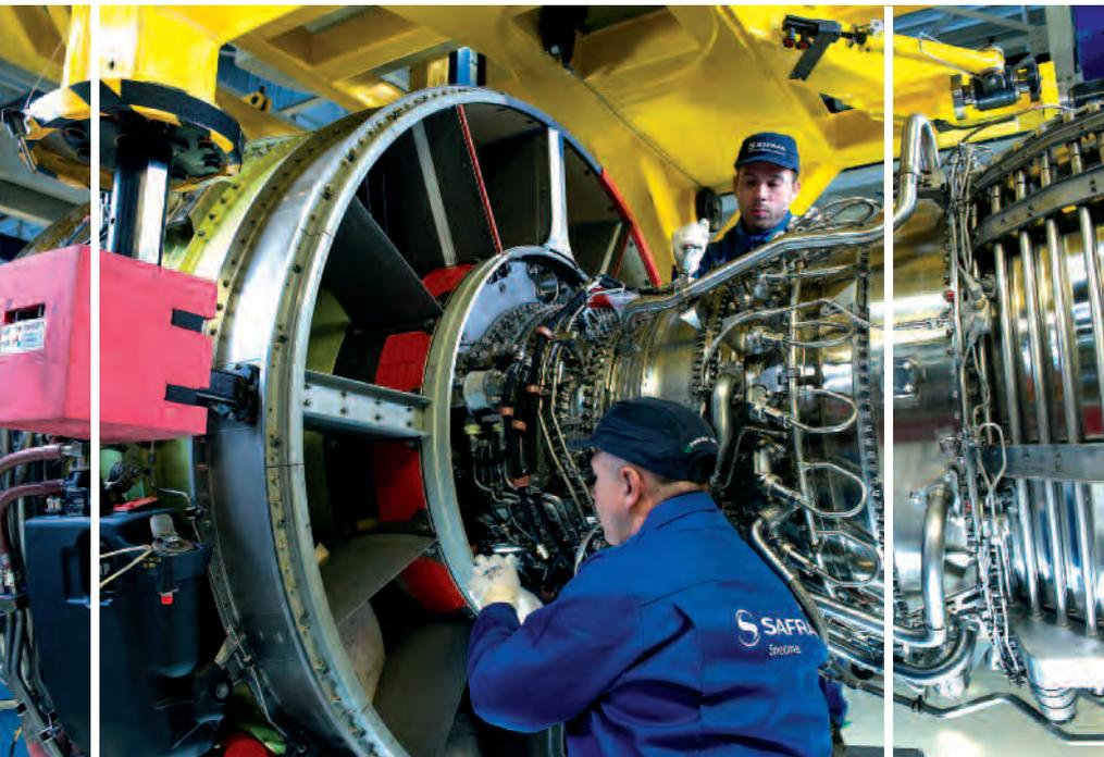
Sur cette ligne d'assemblage, ce ne sont plus les opérateurs qui se déplacent vers le moteur, mais c'est le moteur, suspendu sous une balancelle, qui avance de poste à poste et reçoit de nouveaux composants.
