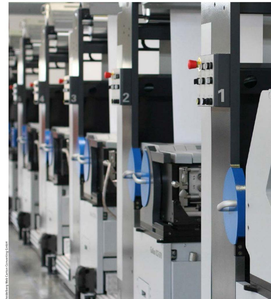
Das voll modulare Druck- und Inline-Converting-System ICS 670 ist konzipiert für die hoch flexible Produktion hochveredelter Verpackungsprodukte
