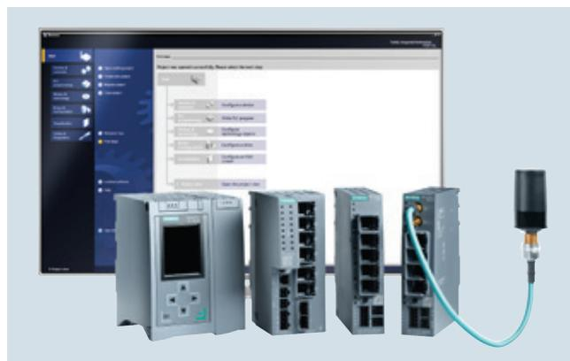
すべての産業セキュリティ機器およびリモートネットワークコンポーネントを TIA ポータルに統合し、そこでエンジニアリングすることができます。さらに、セキュリティ通信プロセッサが TIA ポータル経由で自動的にファイアウォールルールに割り当てられます。
