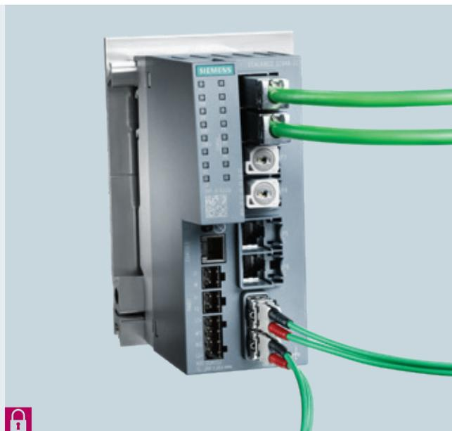
SCALANCE S 産業セキュリティ機器は、ディスクリット製造およびプロセス製造における機器やネットワークのセキュリティを提供し、ステートフルインスペクションファイアウォールや仮想プライベートネットワーク (VPN) などのメカニズムによって産業用通信を保護します。
