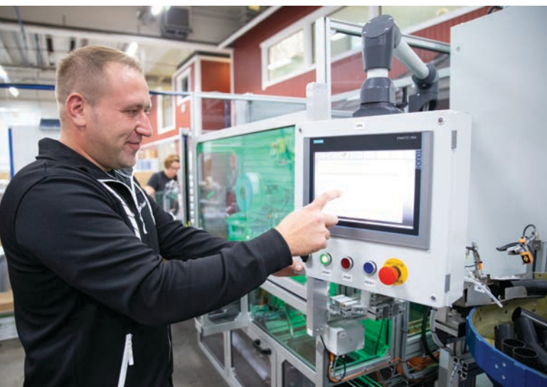
Kone Kuusiston toimitusjohtaja Eemeli Kuusisto asettamassa tuotteen reseptiä teippiharjan rullauskoneen operointipaneelilla.
