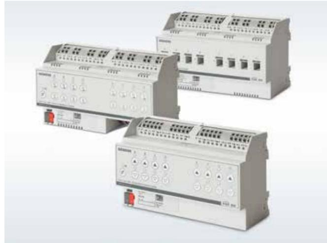
Die neuen Sonnenschutzaktoren mit acht Kanälen eignen sich zur Ansteuerung von Wechsellspannungsantrieben bis maximal AC 230 V: Unterschiedliche Sonnenschutzbehänge, Türen, Fenster oder Lüftungsklappen werden damit betrieben. Die Aktoren zeichnen sich durch wartungsfreie Klemmen zum schnellen Anschluss und einfachen Durchschleifen von unbehandelten Leitern aus.
