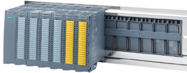
Die neuen hochkanaligen Module für Simatic ET 200MP/S7-1500 minimieren den Footprint von dezentralen und zentralen Stationen. Insgesamt vier neue Digitalmodule mit je 64 Kanälen und zwei Analogmodule mit je 16 Kanälen ermöglichen eine platzsparende und kosteneffiziente Montage von hohen Kanalzahlen im Schaltschrank. Mit dem neuen aktiven Rückwandbus für dezentrale Simatic ET 200MP-Stationen ist ein Hot Swapping von Modulen möglich: Falls Module ausfallen, können diese bei
