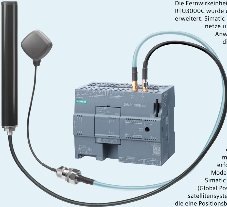
Die Fernwirkereinheit (Remote Terminal Unit, RTU) Simatic RTU3000C wurde um eine zusätzliche Hardware-Variante erweitert: Simatic RTU3041C für LTE-M/NB-IoT-Mobilfunknetze und GPS-Funktionalität. Sie erschließt Anwendern neue Möglichkeiten, denn durch die Mobilfunkstandards LTE-M und NB-IoT (Narrowband-Internet of Things) lassen sich höhere Reichweiten und damit eine bessere Netzabdeckung erzielen. Außerdem können Modi mit einem geringeren Stromverbrauch eingesetzt werden.
