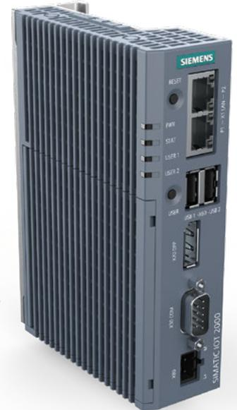
Mit IoT-Gateways lassen sich zukunftsgerichtete Fertigungskonzepte in einer bestehenden Anlage realisieren. Die neue Generation verfügt über eine deutlich verbesserte Performance: Simatic IOT2000 vereint die neueste Prozessorgeneration mit 2 GB DDR4 RAM mit integriertem eMMC-Speicher und vorinstalliertem Simatic Industrial OS.
