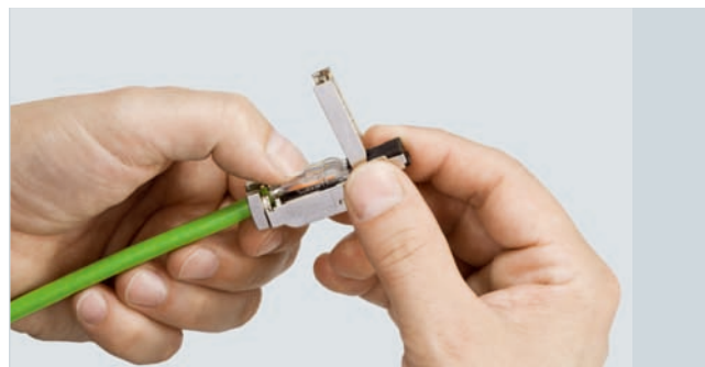
カラーコードに従ってエンドストップまで芯を挿入し、接点ぶたを押し下げます
