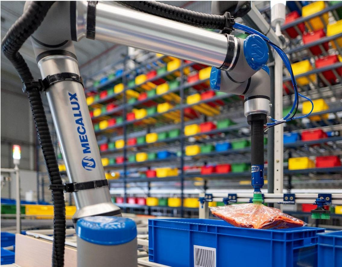
Die 3D-Bildverarbeitungssoftware Simatic Robot Pick AI ermöglicht Robotern das Greifen beliebiger Artikel in Lagerkommissionieraufgaben, unabhängig von Form und Größe.
