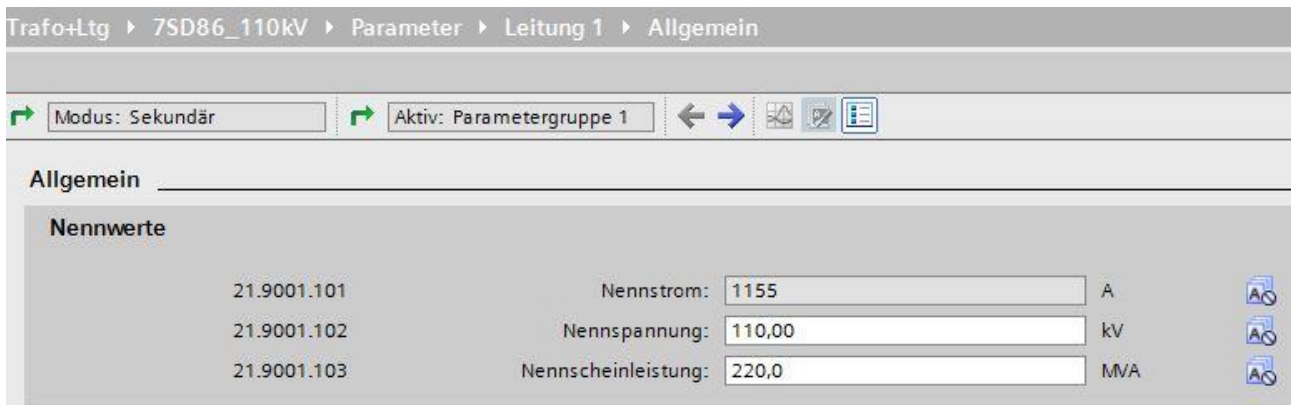
Abbildung 2 - Sekundärwicklung: Parameter à Leitung à Allgemein à Nennwerte
