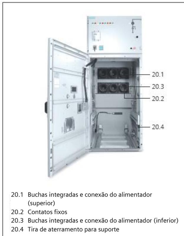
Fig. 20: Vista no compartimento do disjuntor com o obturador aberto
