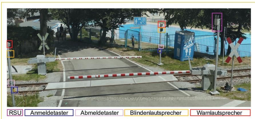
Abb. 1: Rail2X-Testaufbau
