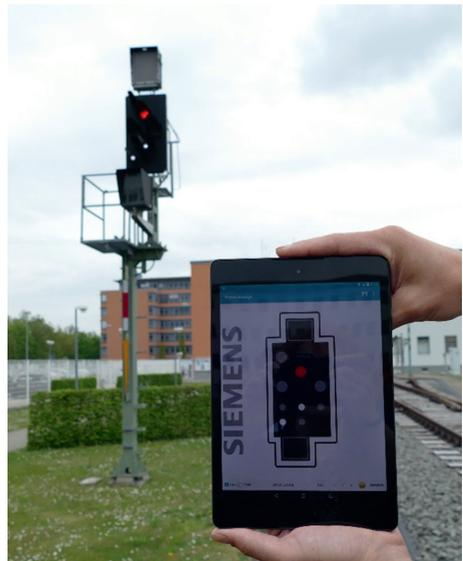
**Abb. 7:** Signalabgriff an einem KS-Signal
