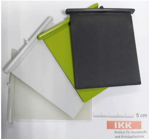
Diese, aus recycelten Materialien hergestellten Kunststoffplatten, wurden für das Training des NIR-Sortiersystems verwendet.
