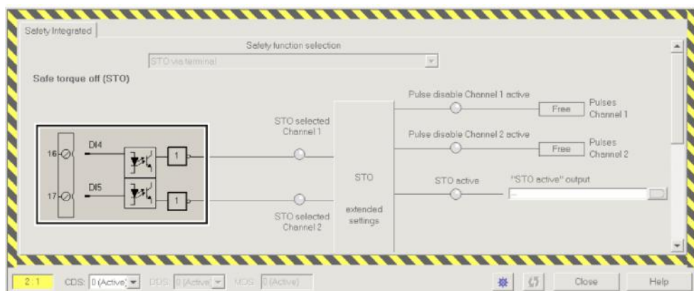
Rysunek 8-30 Przykład: automatyczne powiązanie wejść cyfrowych DI 4 i DI 5 przez STO
