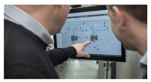
Digital Twin: BRAUMAT erstellt einen digitalen Zwilling der Brauanlage und visualisiert sämtliche relevanten Parameter. ©Siemens
