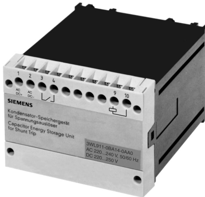
La unidad de almacenamiento de energía de condensador 3WL9111-0BA... es una bobina de reactancia para el disparador de tensión. Puede accionar un disparador con una orden de CIERRE permanente. Gracias a su acumulador de energía, permite desconectar una vez el interruptor automático con el disparador de tensión tras un fallo de la tensión de servicio durante el tiempo de retención.
