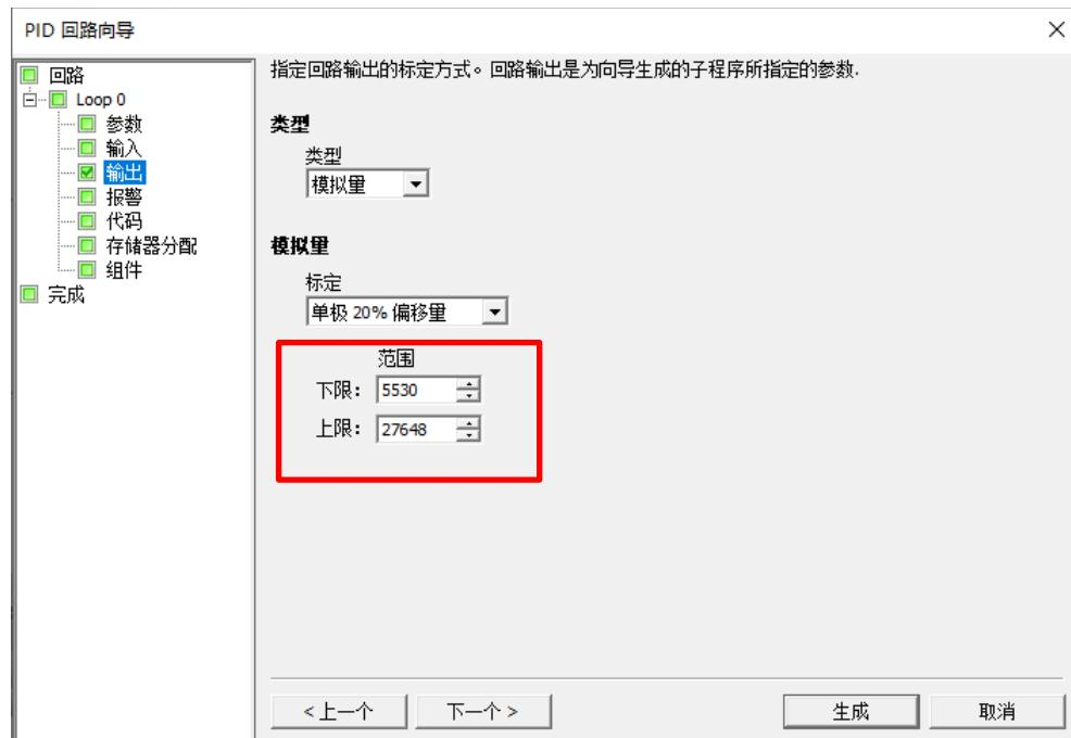
2. 设置斜坡功能块的 min 和 max, 对应上一步的模拟量输出标定范围 5530~27648,
