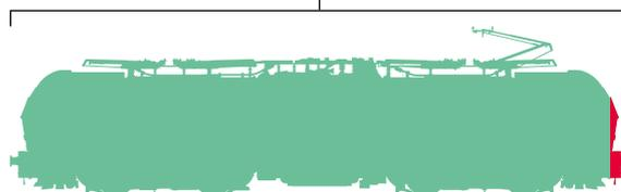
Umweltverträglich über den gesamten Lebenszyklus: Bei einem Gesamtgewicht von 85 t und einer Verwertungsquote von 98% verbleiben nach dem Recycling einer Vectron-Elektrolokomotive nur 1.700 kg Restmaterial. Ein Gewicht, das dem einer Mittelklasse-Limousine entspricht.
