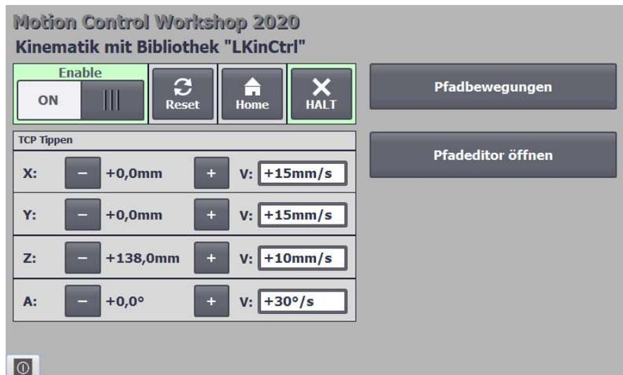
4. Schalten Sie die Kinematik mit allen Achsen ein
