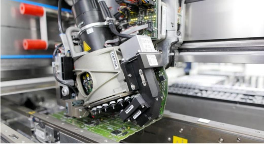
Bei der Leiterplattenbestückung liefert ein KI-gesteuertes Modell verlässliche Aussagen über die Fehlerwahrscheinlichkeit der Flachbaugruppen.
