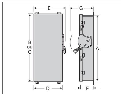
① Aucune débouchure sur les interrupteurs de type 4/4X et 12 et sur les interrupteurs de 800 et 1 200 A.
