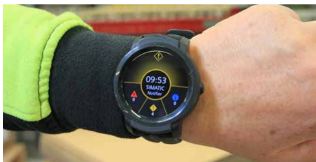
Malin Rosenholm, maskinoperatör på Spaljisten, får upp larm- och informationsnotiser på sin smartklocka via Simatic Notifier.
