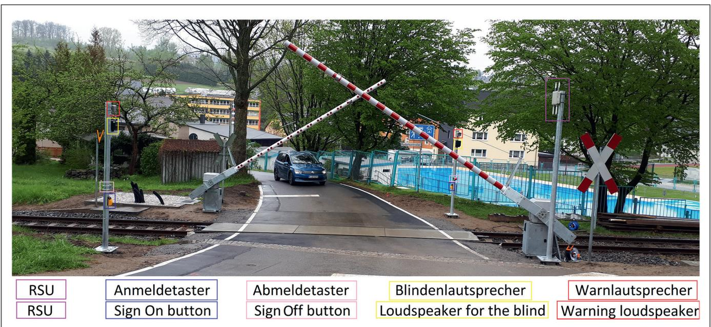
Bild 1: Rail2X-Testaufbau
