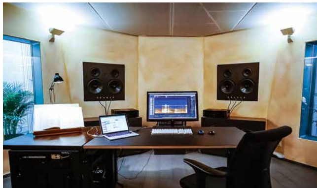
Das maßgeschneiderte Lautsprechersystem in der akustisch optimierten Masteringregie reicht bis 18 Hz hinunter.
